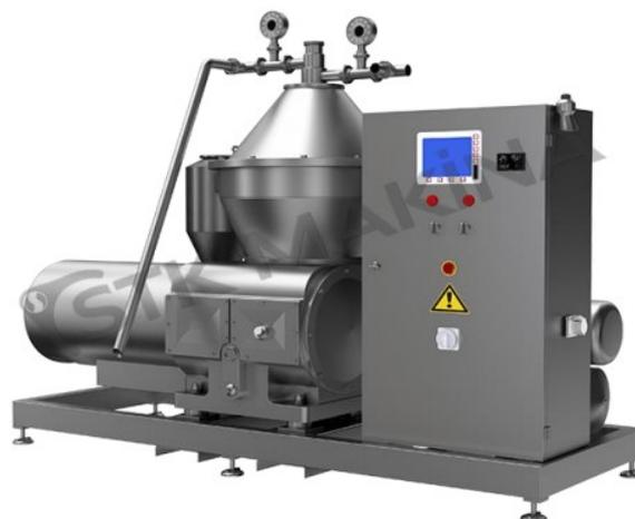
El separador de crema tiene limpieza automática rotativa. El tambor giratorio se ajusta en el panel de control y se descarga la impureza. El tambor rotatorio funciona con agua de operación. El tambor tiene alta durabilidad mecánica y está fabricado en acero inoxidable DIN 1.4462 mediante el uso de alta tecnología.
